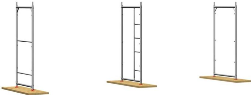
В башмаки поочередно установить на необходимую длину лесов рамы первого яруса, соединяя их горизонтальными и диагональными стяжками. По краям необходимой длины лесов установить рамы с элементами ограждения, а следующая рама должна быть с лестницей.
