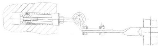
Схема крепления лесов к стене
